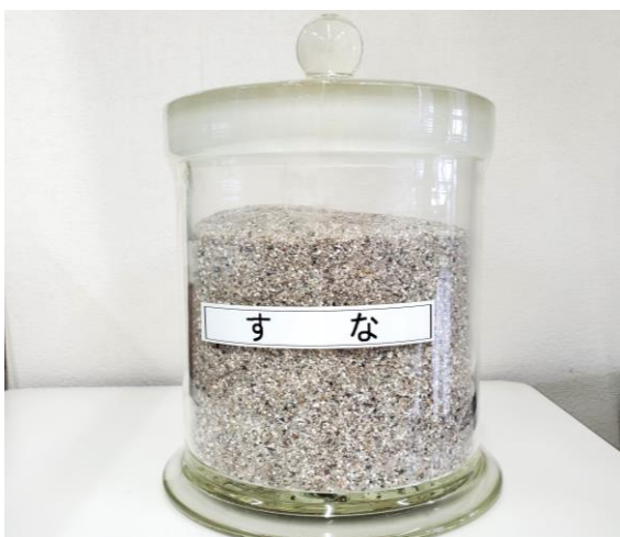
◎焼却炉の中に実際に投入している砂
