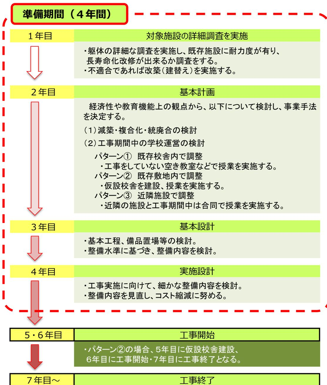
図 5-2 長寿命化改修工事の進行フロー（案）
